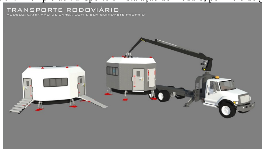
Figura 01: Exemplo de transporte e instalação do módulo, por meio de guincho.
